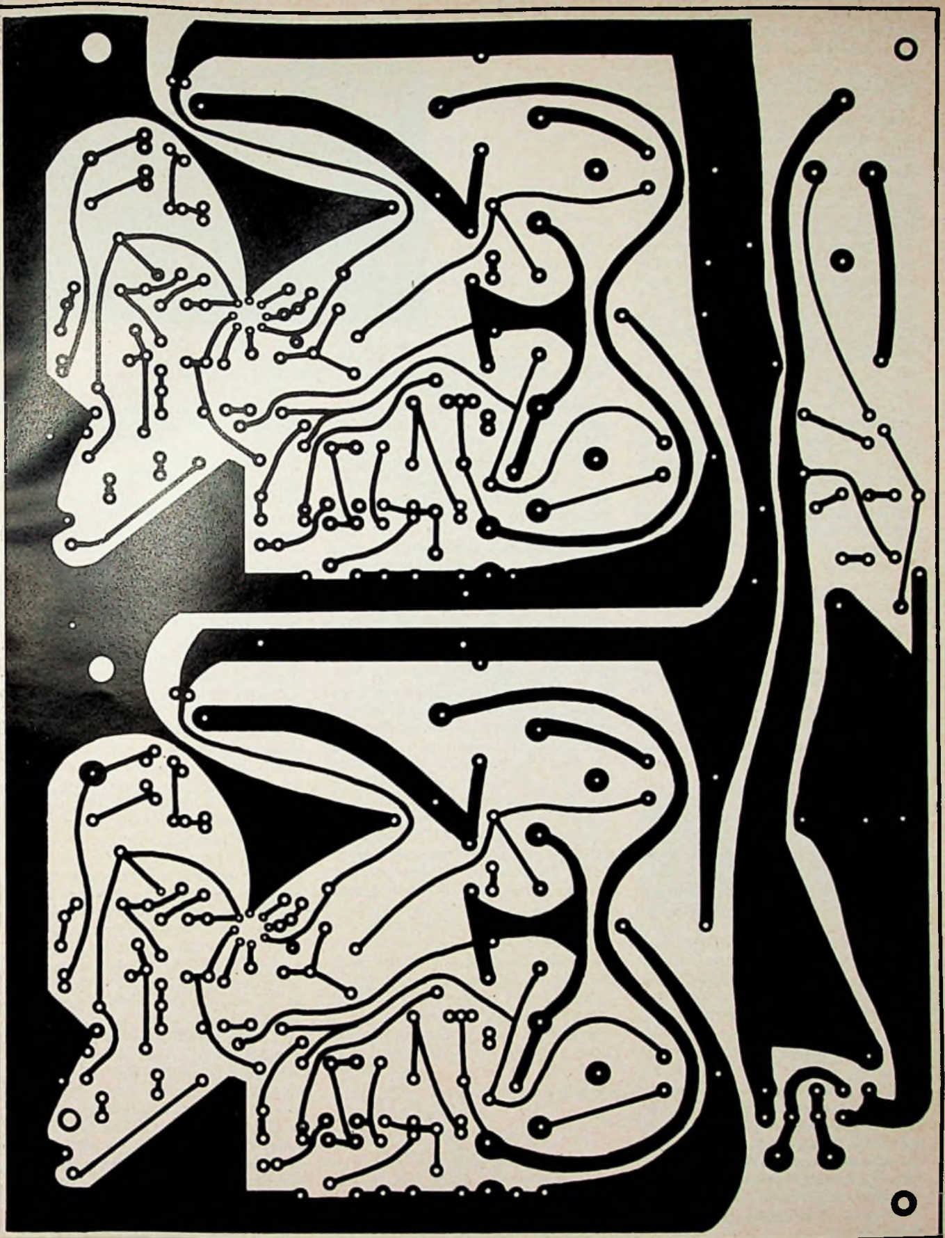
Fig. 10. Stereo-uitvoering van de schakeling (zonder RIAA correctie) van fig. 9, compleet met voeding. De componentenopstelling is op de vorige pagina gegeven, echter gezien vanaf de onderzijde van de print.
